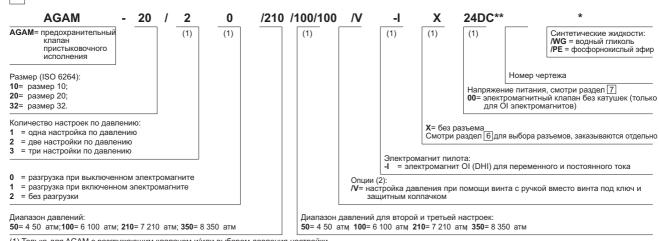
(1) Только для AGAM с разгружающим клапаном и/или выбором давления настройки (2) Подробно об исполнении с ручкой на регулировочном винте смотри таблицу
